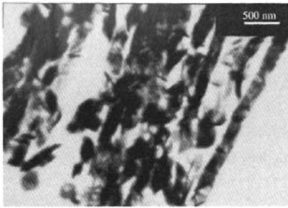
图 3 20 mmol·L -1 的 CdCl 2 溶液与 40 mmol·L -1 的 NaOH 溶液在电位 2 V 电沉积 60 min 下 Cd(OH) 2 的 TEM 图
